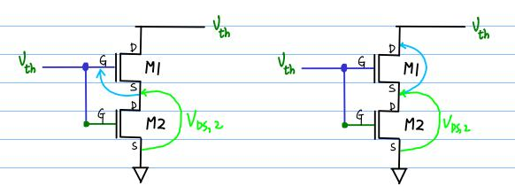
$$V_{GS_1} = V_{th} - V_{DS_1}$$
