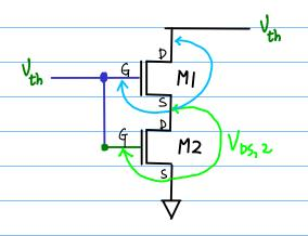
$$V_{th} = V_{GS1} + V_{DS2}$$
